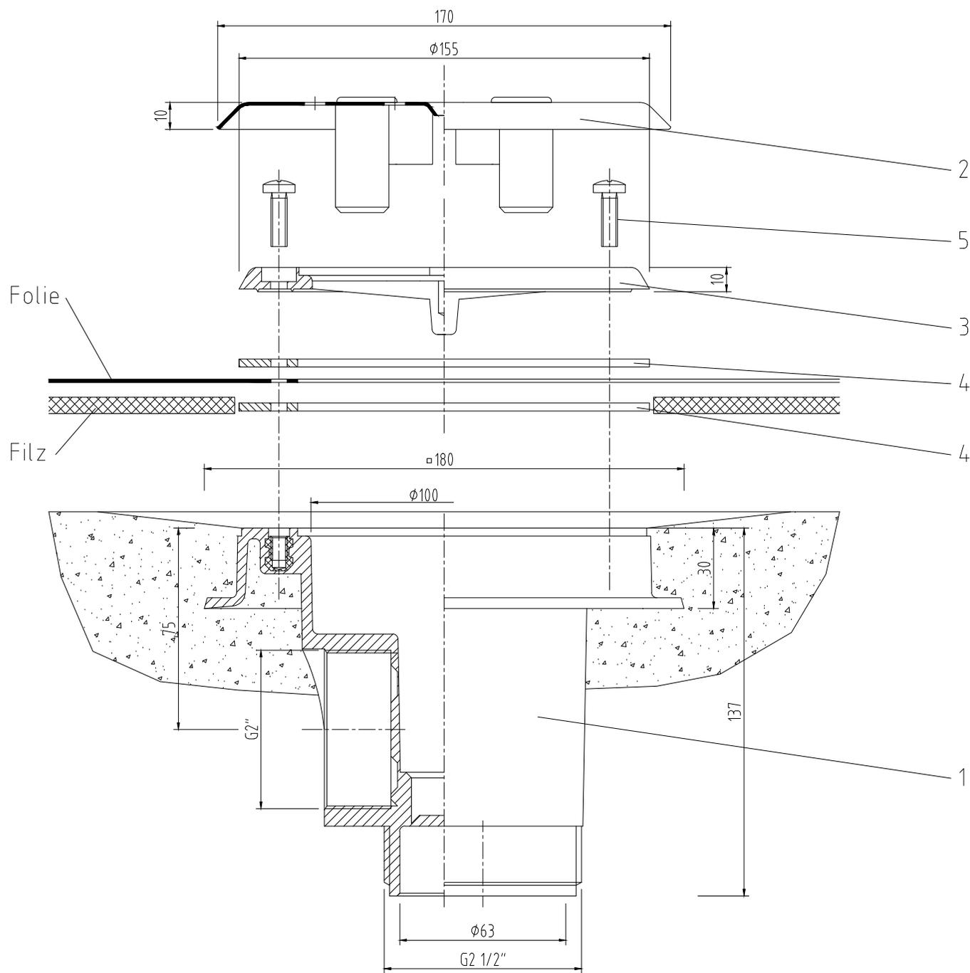
Bodenablauf ABS cw 2" mit Abdeckblende Niro V4A 4824
