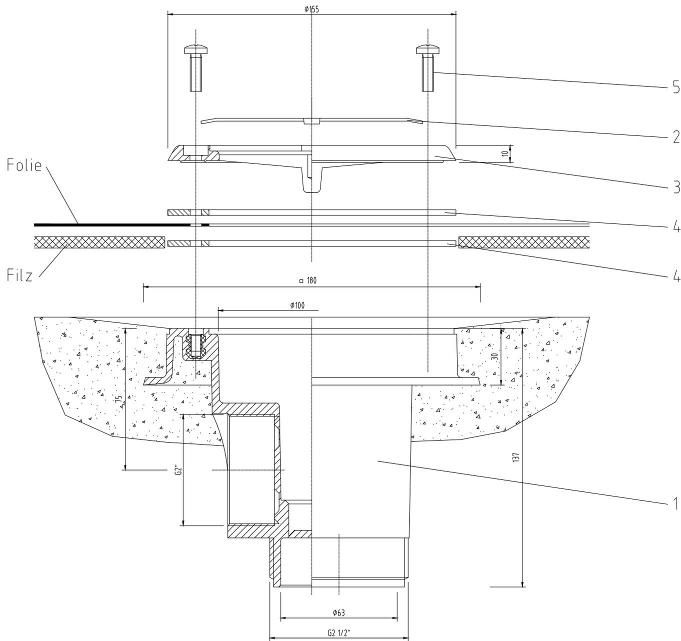
Bodenablauf ABS grau 2" mit Einlegerost Niro V4A 48145
