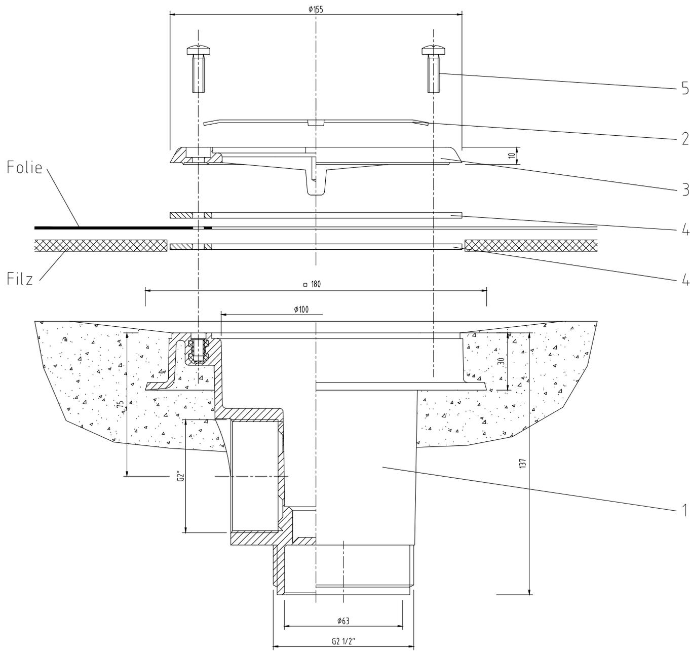
Bodenablauf ABS cw 2" mit Einlegerost Niro V4A 4814
