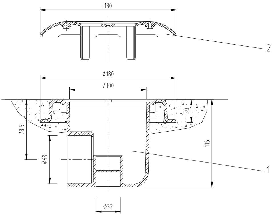
Bodebabauf ABScw 63mm mit Abdeckblende ABScw 4335 zum Einsatz in Betonbecken
