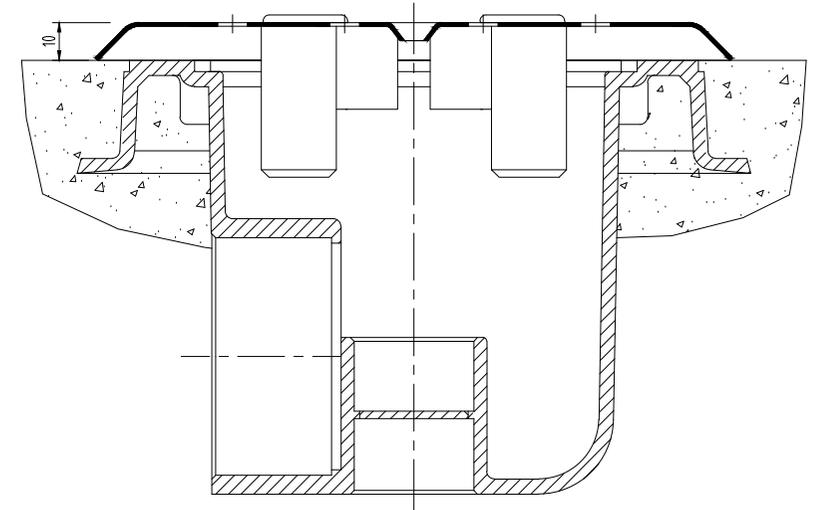
Bodenablauf ABSw 63mm mit Blende Niro V4A 4325
