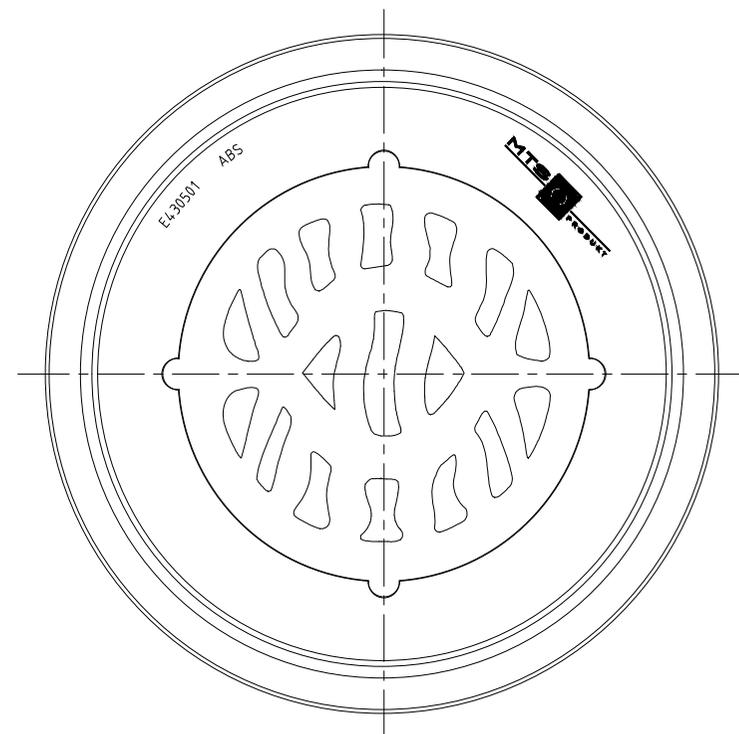
Bodenablauf ABSchw 63mm mit Einlegerost Niro V4A 4315
