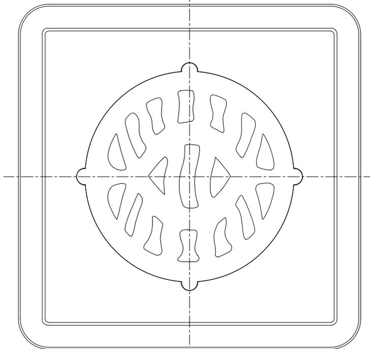
Bodenablauf ABS cw 2" mit Einlegerost Niro V4A 4314
